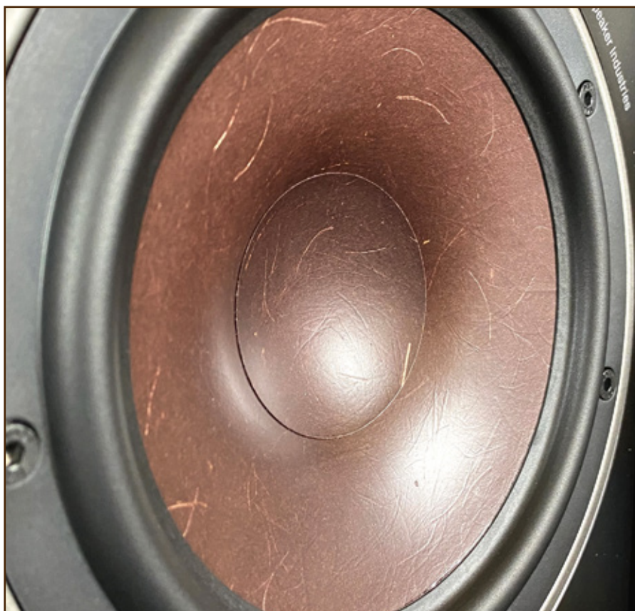
Auch die charakteristisch gefärbte, rote Papiermembran wurde entwickelt, um dem Tiefmitteltreiber extrem schnelle Eigenschaften zu verleihen
