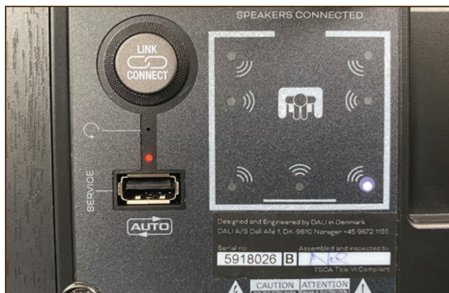
Über die Link-Connect-Taste lässt sich sehr einfach die dedizierte Position des Lautspeakers im Setup definieren. Bis zu 7.1 ist kabellos möglich, denn der Hub hat einen Sub-Out
